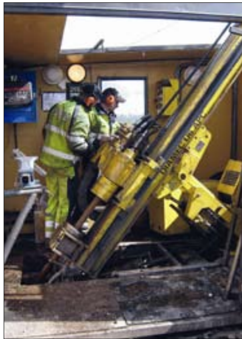
▲ Sverige har en intressant berggrund som lockar många utländska prospekteringsföretag. Bilden visar provborring med en diamanthörningsmaskin.
