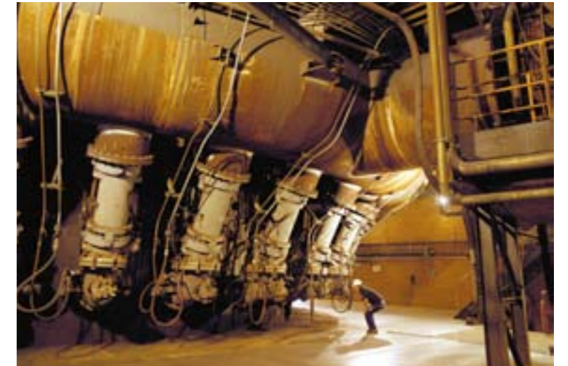
▲ Dagens masugnar har helt andra dimensioner än tidigare generationers. Bilden visar den nedre delen av den 40 meter höga masugnen i Luleå, den största av Sveriges tre masugnar. De andra två finns i Oxelösund.
